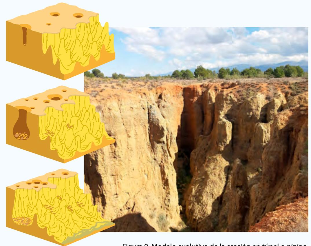
Figura 9. Modelo evolutivo de la erosión en túnel o *piping*.
