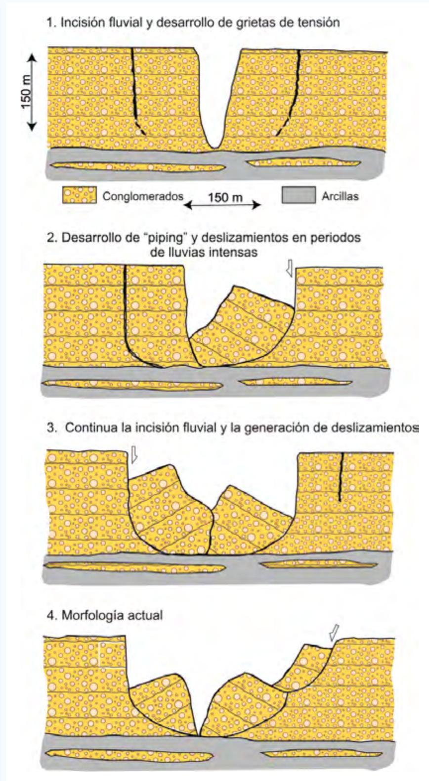
Figura 4. Esquema evolutivo de los deslizamientos rotacionales del arroyo de Gor.
