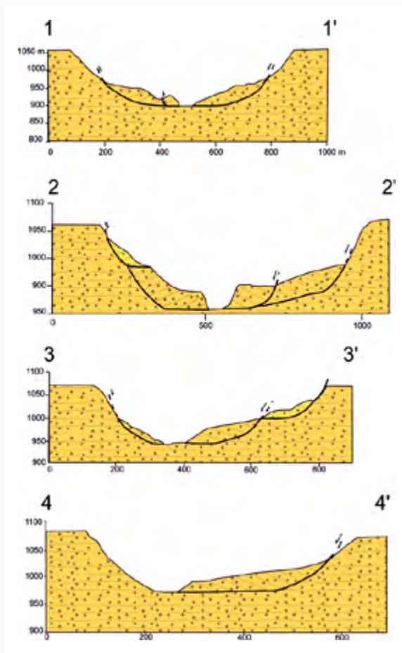
Figura 3. Deslizamientos rotacionales en el Arroyo de Gor. Perfiles transversales que muestran la geometría de los deslizamientos de ladera en el Arroyo de Gor.
