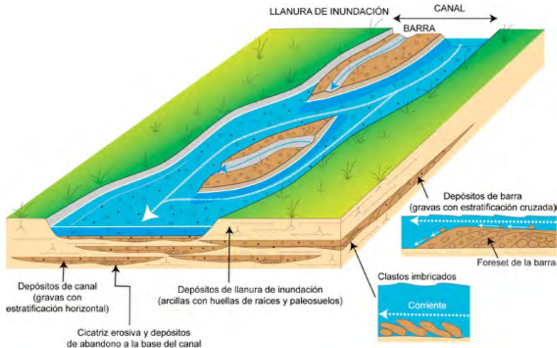
Figura 2. Componentes principales de un sistema fluvial trenzado
