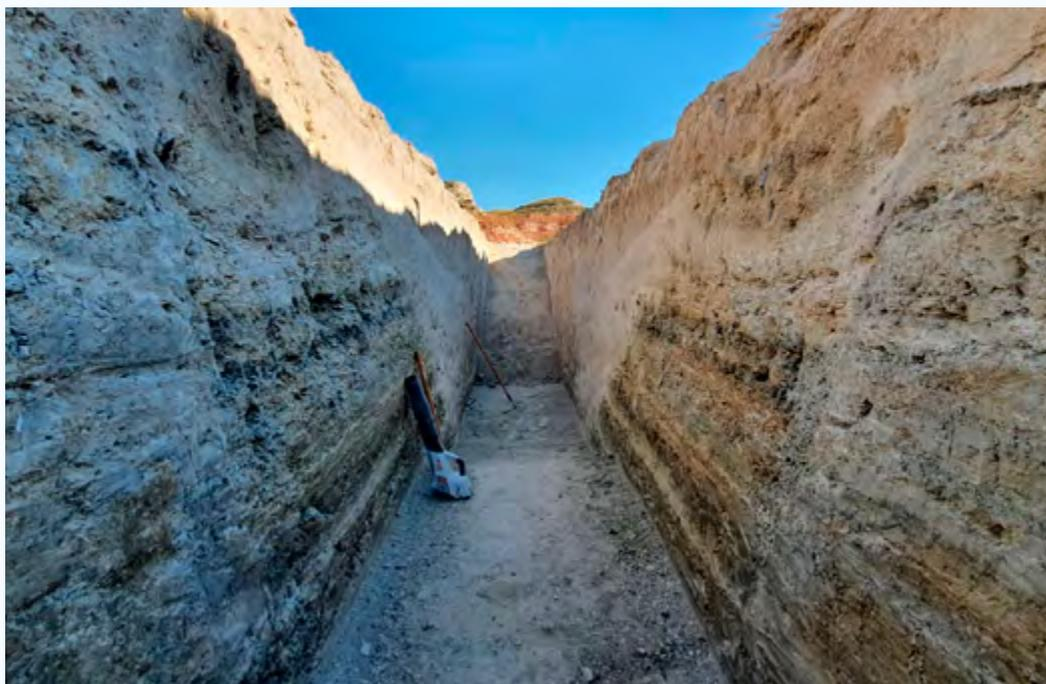
Figura 4. Interior de una zanja de paleosismicidad realizada en la falla de Galera para la identificación de paleoterremotos.
