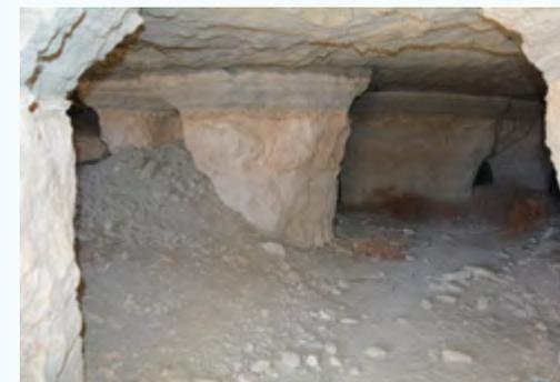
Figura 2. Minas del Alcázar. Excavación minera en Galera para la explotación del yeso masivo.
