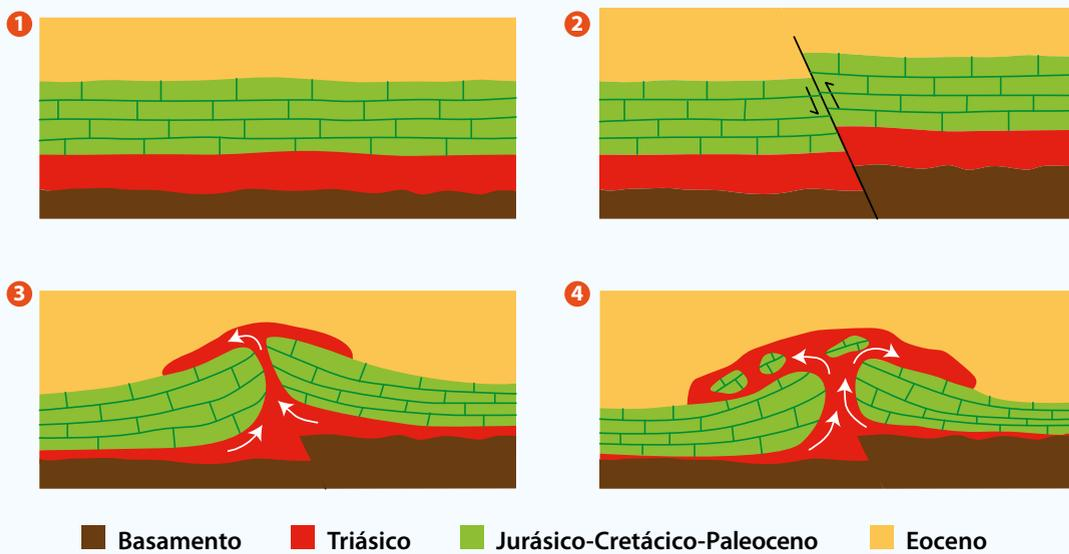
Figura 3. Funcionamiento de un *diapiri* asociado a fallas inversas. Los materiales menos densos, como yesos y arcillas (en color rojo), ascienden a favor de las fracturas, atravesando los materiales superiores, más densos y resistentes.
